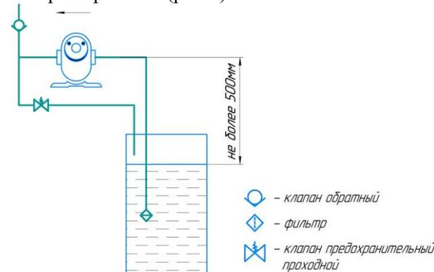
Рисунок 5 - Установка насоса выше уровня рабочей жидкости
