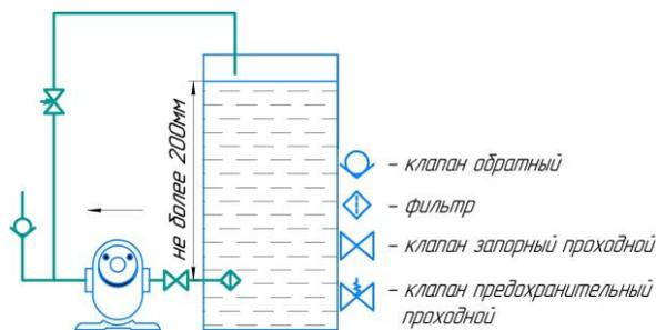
Рисунок 6 – Установка насоса ниже уровня рабочей жидкости
