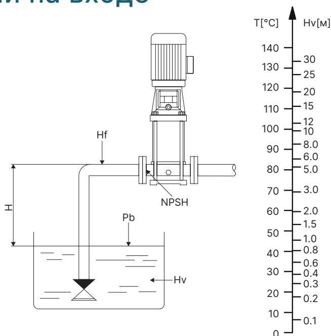
Давление в закрытом трубопроводе может быть принято в соответствии с давлением (бар) в закрытой системе.
