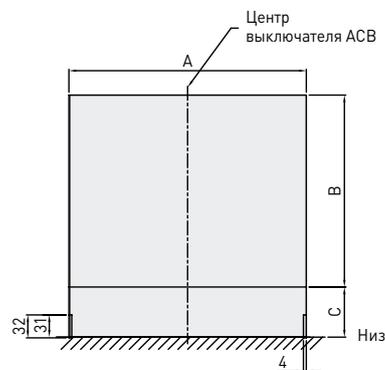
Значения всех размеров для прорези в задней панели
