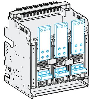
Вращение клемм возможно только для типов HGS/HGN типоразмера А 630~1600 А и типоразмера В 2000~3200 А. Фронтальный тип - это тип клемм, который подходит для распределительных устройств с ограничениями по размерам.
