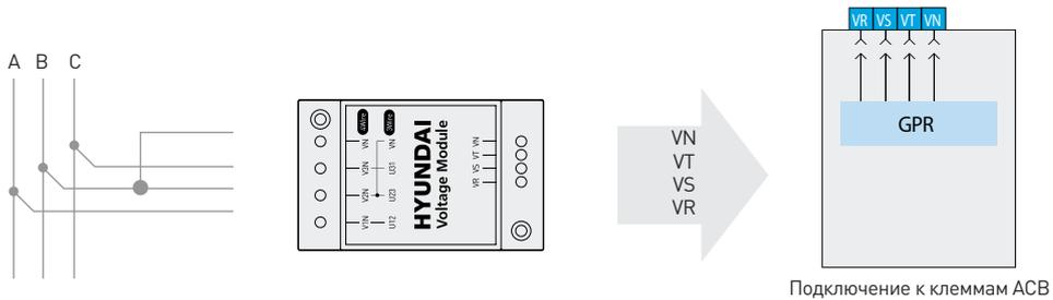
4 полюса 4 провода/3 полюса 4 провода
