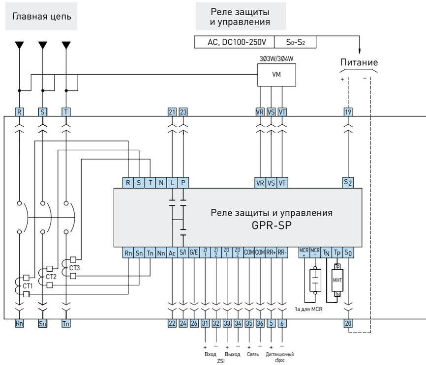
\* В случае реле моделей 52-62 (GPR-LAG) 53-63 (GPR-LAZ), длина проводов подключения ТТ к выводам 27, 28 должна быть не больше 5 м. Длина провода дистанционного сброса (RR) к выводам 5 и 6 должна быть не больше 5 м.
