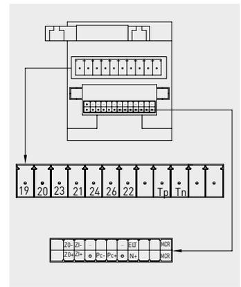
**Обозначение клемм (ручное подключение)**
