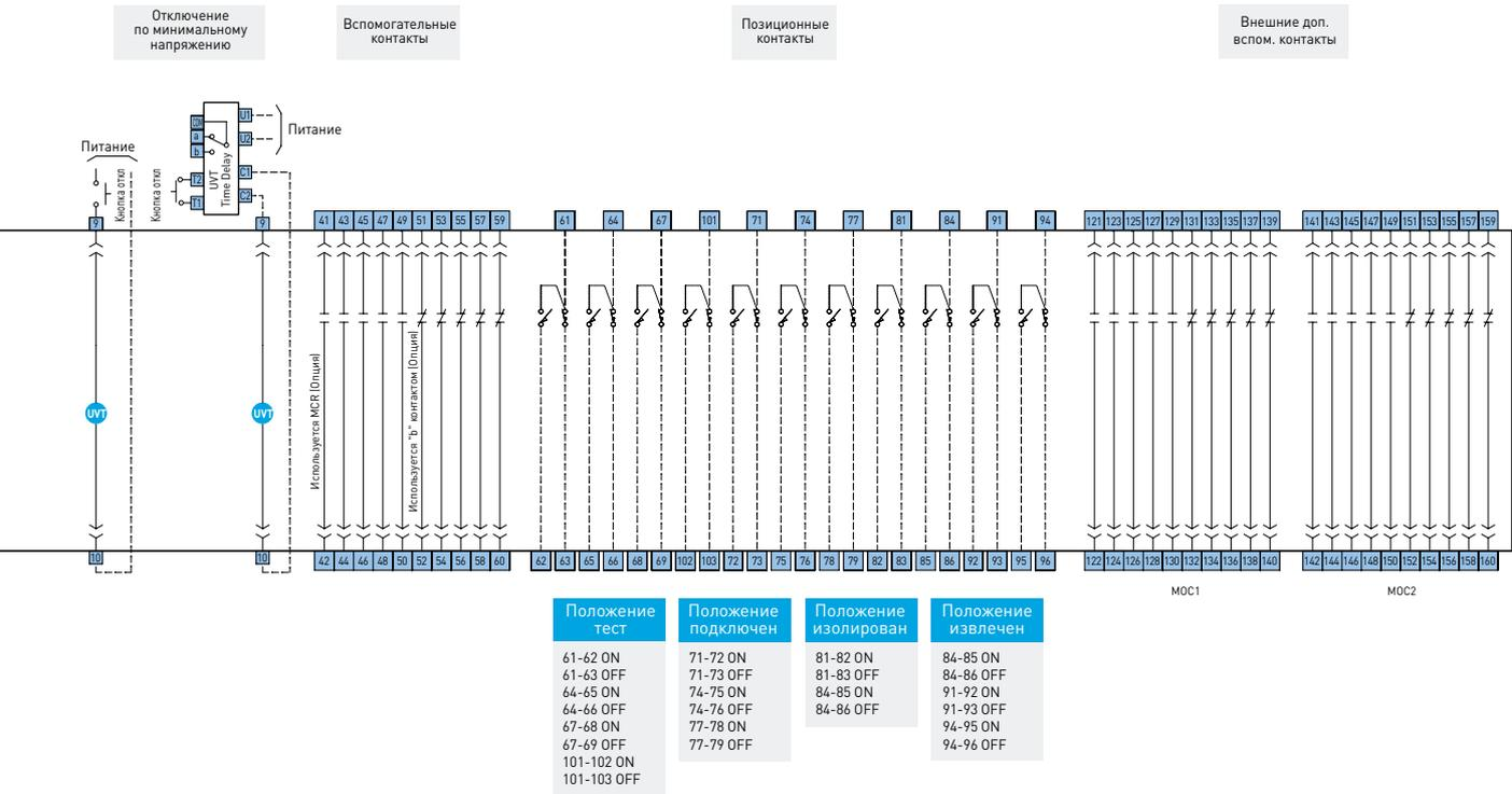
**Обозначение клемм (автоматическое подключение)**
