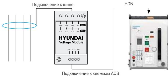
\* Длина соединительного кабеля между модулем напряжения и выводами VR, VS, VT должна быть не более 150 мм.
