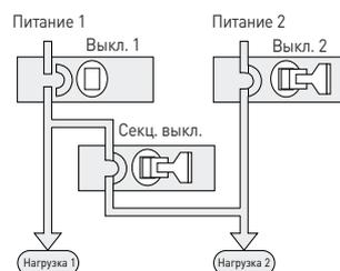
\* Пример: При использовании секционного выключателя предотвращается параллельное питание от двух линий.
