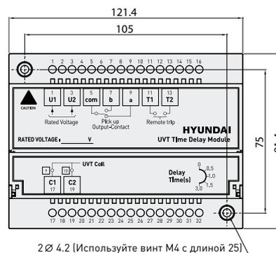
\* Контакт состояния 5, 7, 9 показывает состояние при работе UVT.
