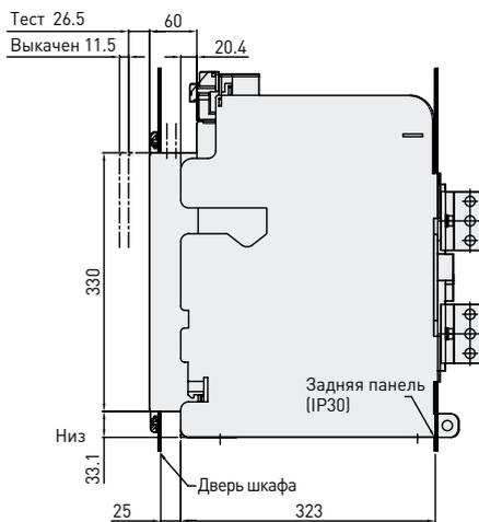
Размеры прорези в задней панели (для IP30)
