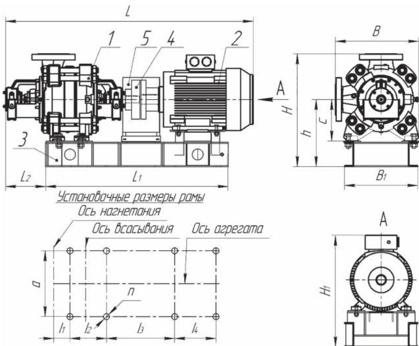
Рис.1.13 Габаритные и установочные размеры агрегатов ЦНС-105...ЦНС300
