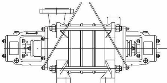
Рис. 2.8. Схема строповки
