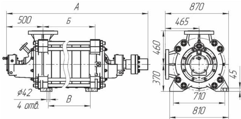
Рис. 1.12 Габаритные и установочные размеры насоса ЦНС300-120...600
