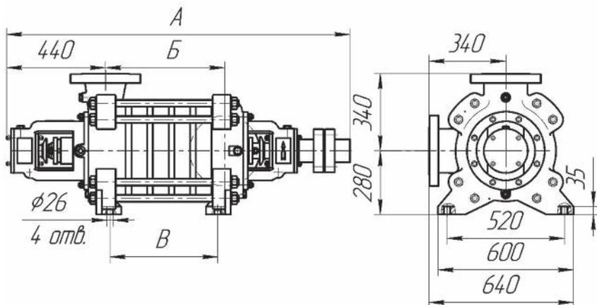
Рис. 1.10 Габаритные и установочные размеры насоса ЦНС105-98...490
