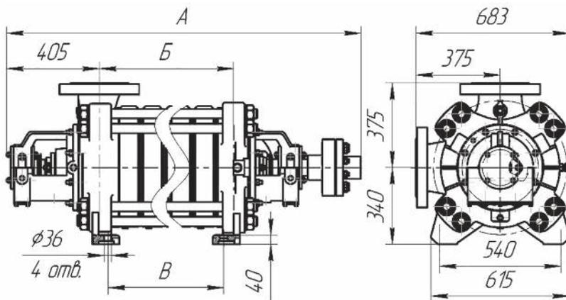
Рис 1.11 Габаритные и установочные размеры насоса ЦНС180-85...425
