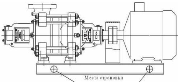
Рис. 2.9. Схема строповки
