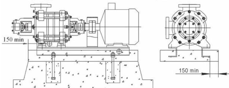
Рисунок 2.2 Установка насоса
