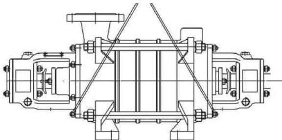
Рис. 14. Схема строповки
