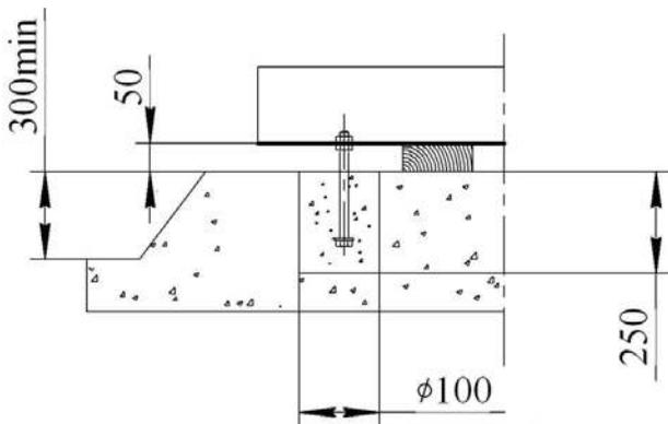
Рис.8 Устройство фундамента
