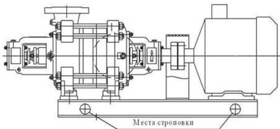
Рис. 15. Схема строповки
