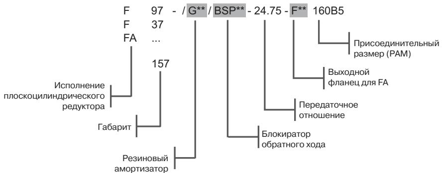
Условное обозначение мотор-редуктора плоскоцилиндрического типа F (FF, FA)
