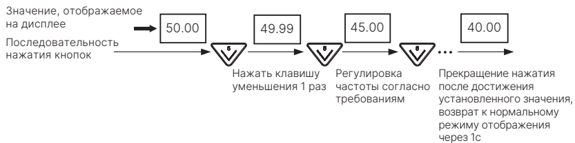
Рис. 5-9 Пример операции регулировки установки частоты
