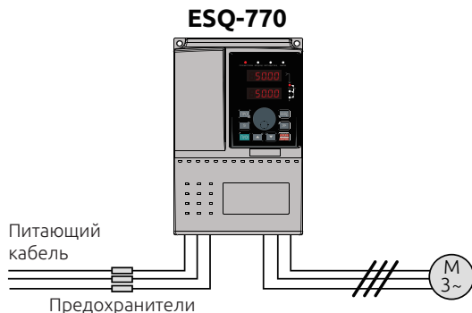
Рисунок 3-30. Схема установки предохранителей.
