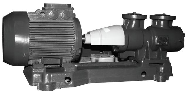
Насосы трехвинтовые типа А1 (А2, А3 и других модификаций) 3В предназначены для перекачивания неагрессивных жидкостей, обладающих смазывающей способностью, без абразивных механических примесей, вязкостью до 1500 сСт и температурой до +100°C (по согласованию с производителем до +150°C). Нижний предел вязкости ограничивается смазывающей способностью перекачиваемой жидкости, верхний — мощностью электродвигателя и всасывающей способностью насоса.
