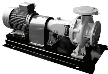
Насосы центробежные консольные типа К и агрегаты электронасосные на их основе предназначены для перекачивания воды (кроме морской), а также других жидкостей, сходных с водой по плотности, вязкости и химической активности, с температурой от 0 до +85°C (+105°C по специальному заказу), pH=6-9, с содержанием твердых включений не более 1% по массе и размером не более 0,2 мм.
