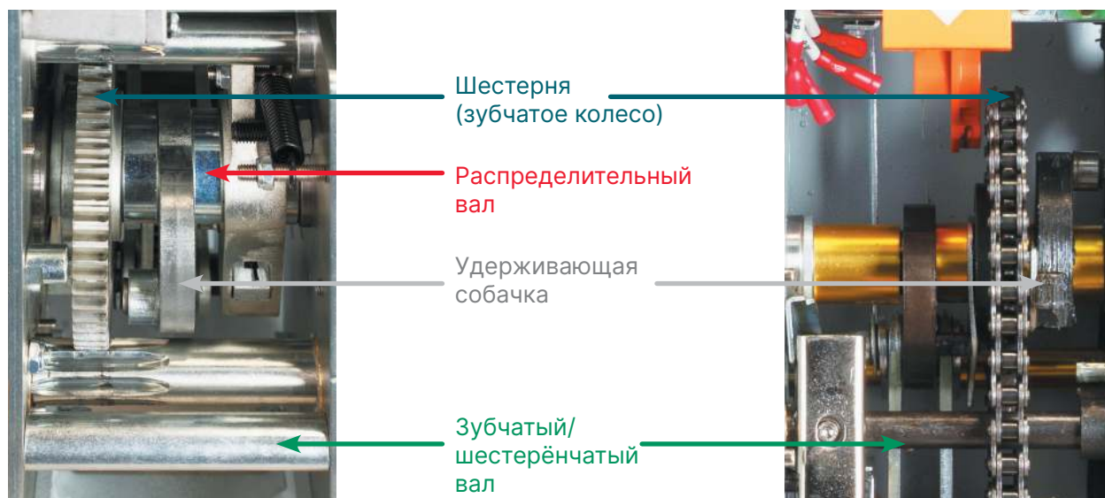
РИСУНОК 7. МЕХАНИЗМ ПЕРЕДАЧИ
